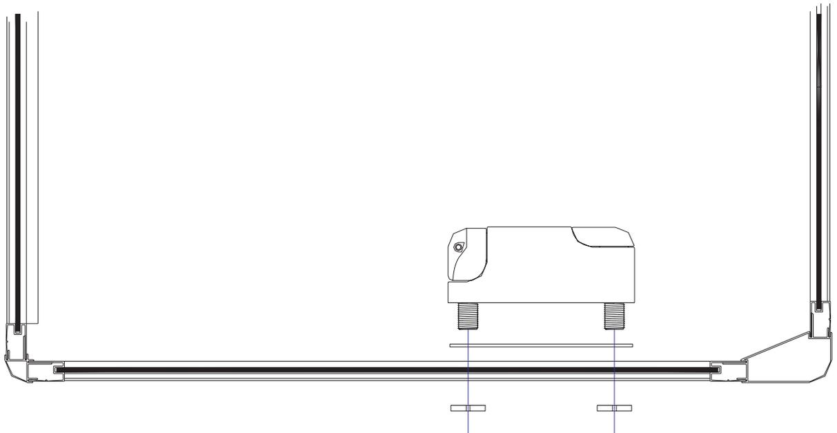
Placera gummilisterna (2) i spåren på över- och underprofil. Fukta dem med tvällösning så underlättas monteringen.
