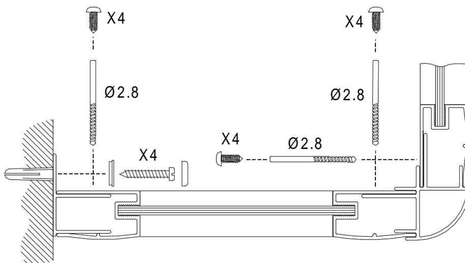
Utanpåliggande rör: Drag rören genom väggprofilerna, säga och fila upp hål i båda profilerna. Täta noga med silikon. Täta noga med silikon mot golv på duschens utsida och mot vägg på duschens insida.
