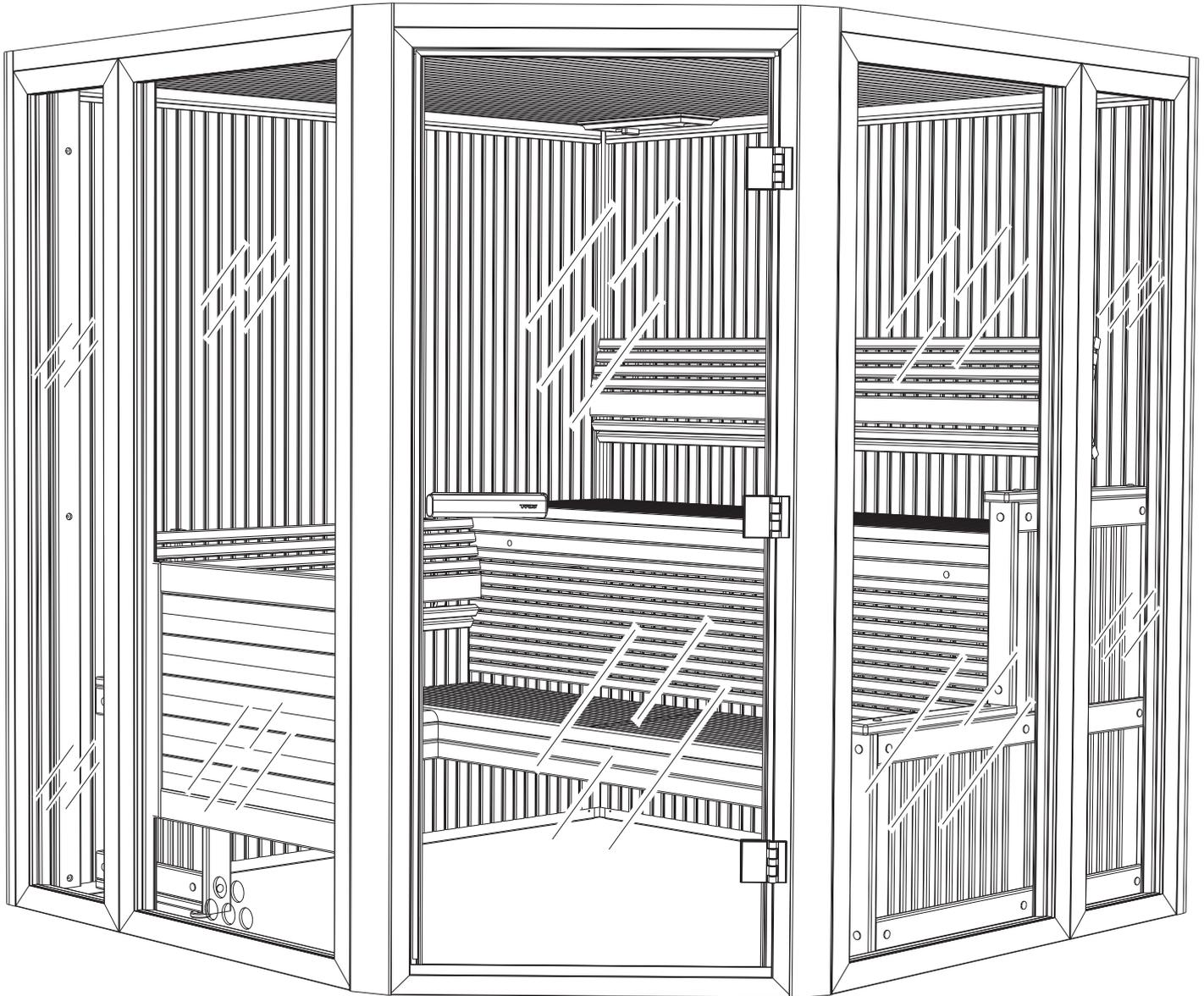
Basturummets layout och i vilken ordning väggarna skall monteras. Denna anvisning visar monteringen av layout 1.
